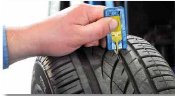
Ist die Profiltiefe geringer als 1,6 Millimeter, sind die Reifen nicht mehr sicher und ein Bußgeld droht. Experten empfehlen vier Millimeter Mindestprofil bei Winterreifen. Foto: djd/Kfzgewerbe
