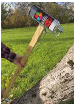
Mit einem einfachen Markiergerät und einer Sprühdose lassen sich Markierungen anbringen, die es einfacher machen, den Stamm auf die gewünschten Stücklängen zuzuschneiden.
